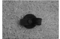
将套管插入到试验孔中并盖上盖子
