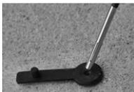
将现场探测器插入到套管中
