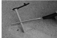
根据测量深度切断套管
