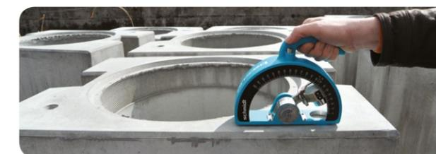
**PT 型：**这一产品配有大型冲击锤表面，特别适用于对软性材料进行测试，如轻质混凝土、灰泥板和新拌混凝土。它通常用于确定取走模板的恰当时间。
