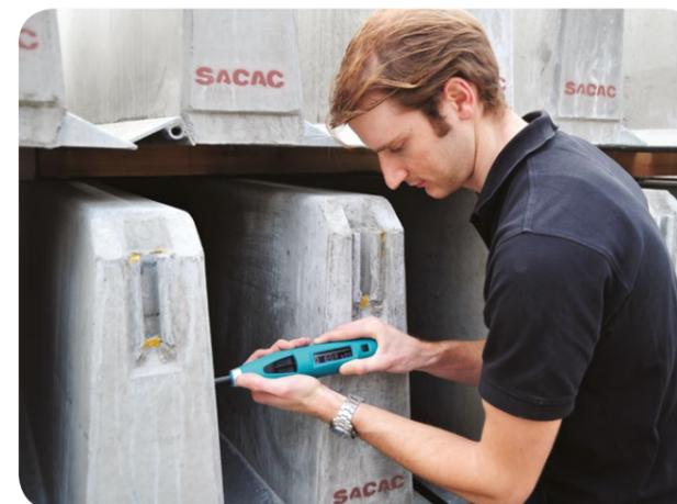
**ST/PC N/L 型：**世界上先进的回弹仪，拥有不可匹敌的离散性、耐久性和测量范围。
